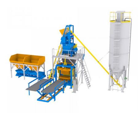
Высокопроизводительный комплекс, предназначенный для изготовления мелкоштучных вибропрессованных изделий: стеновых блоков, брусчатки, тротуарных и дорожных бордюров, лотков, кирпичей и облицовочных камней.
